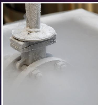
**4. PR2 e FET**, *due prove simili nel processo di testing che si differenziano nel metodo di rilevazione della perdita e nell'utilizzo del gas impiegato per pressurizzare la valvola.*
