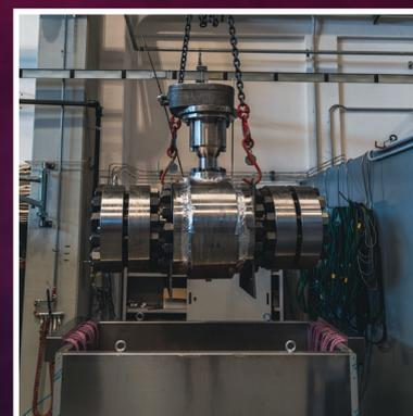
**3. Cryo Test**, *che permette di testare valvole a bassa temperatura, o meglio a -196°C, e di valutare eventuali perdite attraverso lo spettrometro di massa;*
