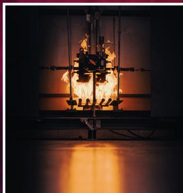
**2. HT Test** oppure *test ad alta temperatura, una prova volta a valutare l'endurance di una valvola e delle sue guarnizioni quando esposta a elevate temperature;*
